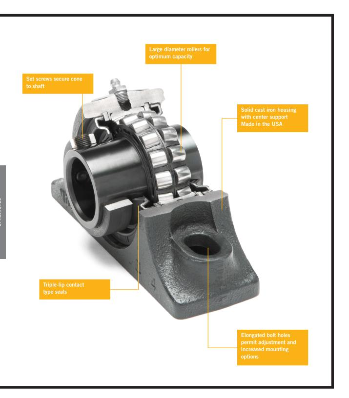
MOLINE M2000 SPHERICAL ROLLER BEARINGS
